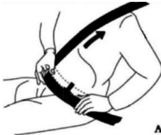
شکل ۳ - تنظیم تسمه کمر بند ایمنی
