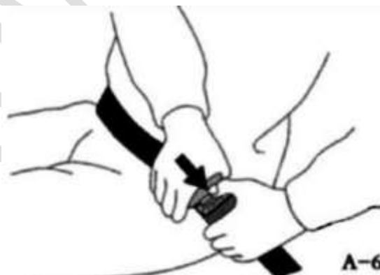
شکل ۴ - نحوه بستن صحیح کمر بند ایمنی دو نقطه‌ای
