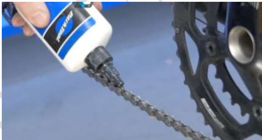
شکل ۸ - اعمال صحیح روغن بر زنجیر از داخل حلقه‌ها برای روان‌سازی کامل
