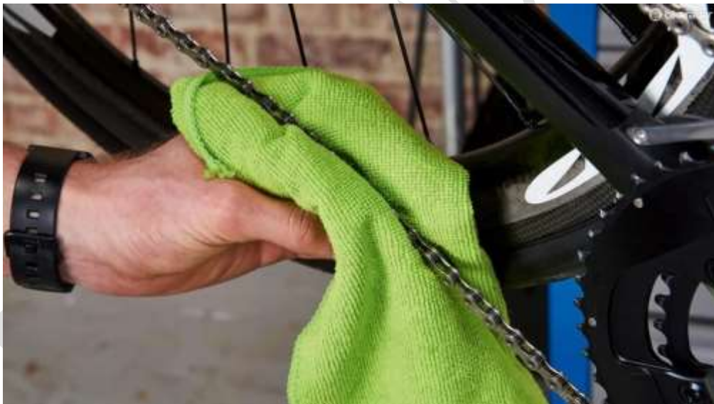
شکل ۷ - مرحله نخست روغن کاری زنجیر دوچرخه: تمیزکاری دقیق زنجیر برای عملکرد بهتر
