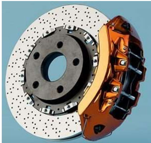
شکل ۱۲ - ترمز دیسکی: عملکرد سریع و خنک‌کنندگی بهتر
