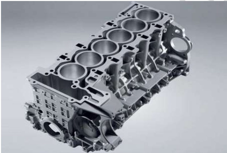
شکل ۲ - موتور خطی (Inline): ساختار و عملکرد سیلندرها در یک خط مستقیم
