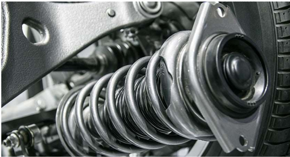
شکل ۱۱ – فنرها: جذب ضربات جاده و افزایش راحتی رانندگی
