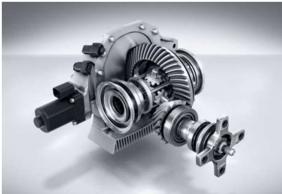
شکل ۹ – دیفرانسیل: تقسیم قدرت میان چرخ‌ها
