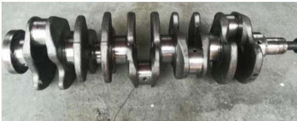
شکل ۶ - میل‌لنگ: تبدیل حرکت رفت و برگشتی به حرکت چرخشی
