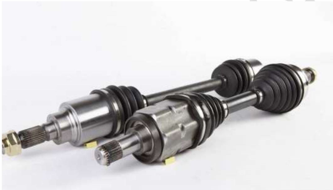
شکل ۱۰ – پلوس: انتقال قدرت نهایی به چرخ‌ها برای حرکت خودرو
