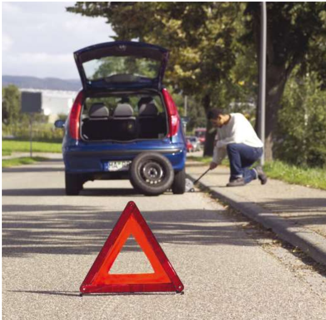
شکل ۹ - مثلث هشدار: ابزار ضروری برای اعلام خطر و ایمنی خودرو در مواقع اضطراری
