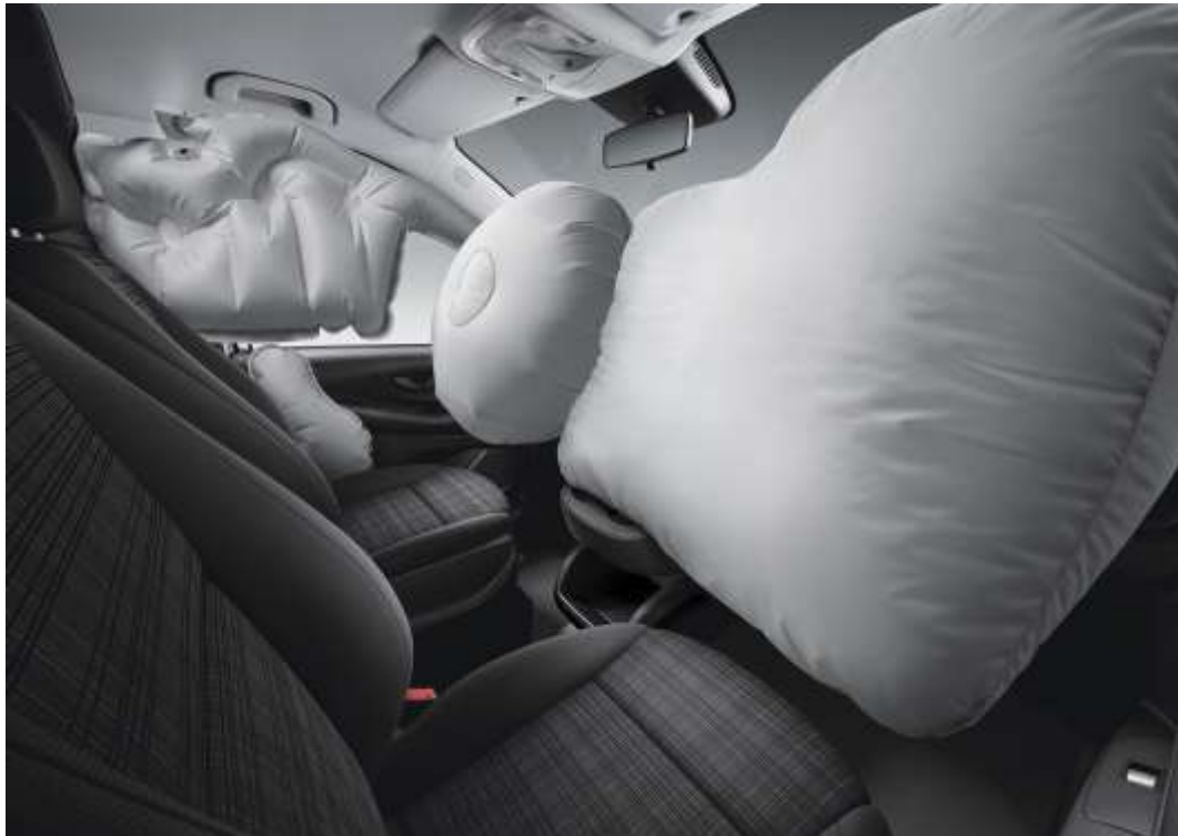
شکل ۵ - کیسه هوا: افزایش ایمنی در تصادفات برای کاهش شدت آسیب‌ها
