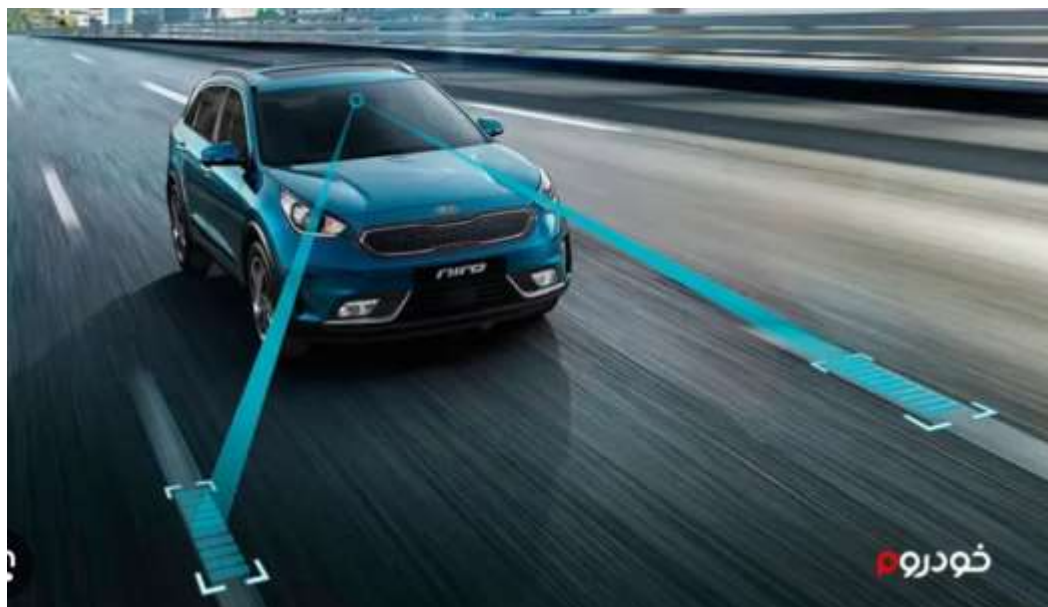
شکل ۲ - سیستم هشدار خروج از خط: افزایش ایمنی با هشدار صوتی و لرزش فرمان
